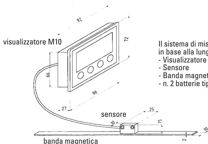
Il sistema di misurazione su banda magnetica viene fornito in Kit, in base alla lunghezza della banda magnetica ed è composto da:
