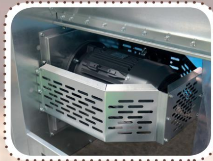
4 OCHRANA ELEKTRICKÉHO MOTORA
